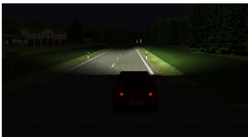
Abbildung 6.5: Beleuchtung durch Xenon Scheinwerfer
