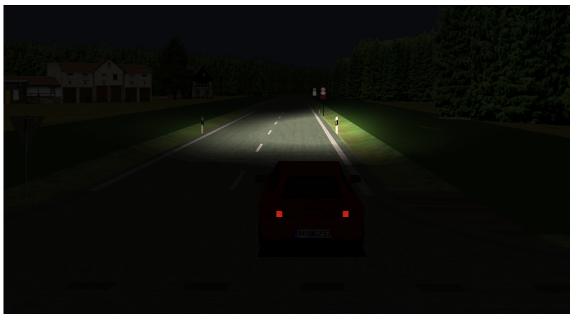
Abbildung 6.4: Beleuchtung durch Halogen Scheinwerfer
