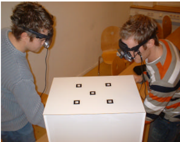
Abbildung 1: Links: Box zum Testen der Beispielapplikation mit Benutzern. Rechts: teiltransparente Datenbrille (Sony Glasstron)
