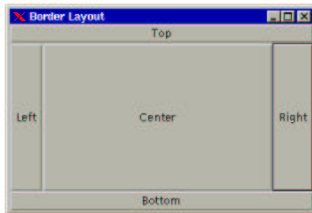
Abbildung 3.6: Demoprogramm zum BorderLayoutmanager. Die Randelemente bekommen Ihre minimale Größe zugeordnet, der Rest bleibt für das zentrale Objekt.
