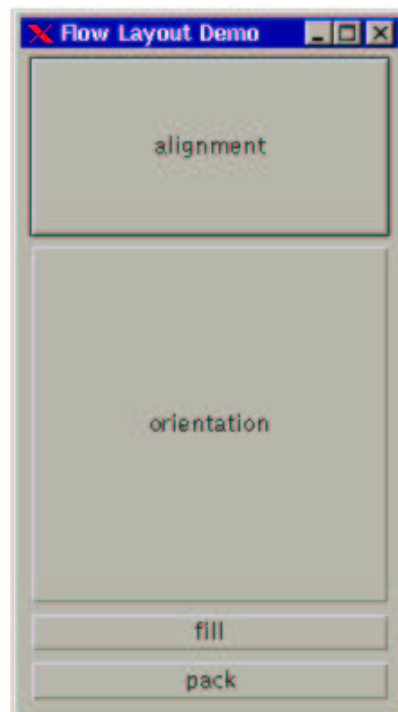
Abbildung 3.4: Die Positionierung der Objekte, nachdem die Orientierung auf Vertikal eingestellt wurde. Weiterhin wurden die Optionen PACK und FILL verwendet.
