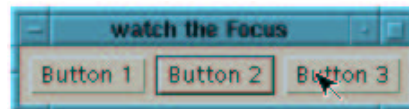
Abbildung 4.3: Beispielprogramm für den Einsatz eines Focuslistener. Sobald der dritte Button gedrückt wurde, wird der Focus sofort den mittleren Button zugeordnet.
