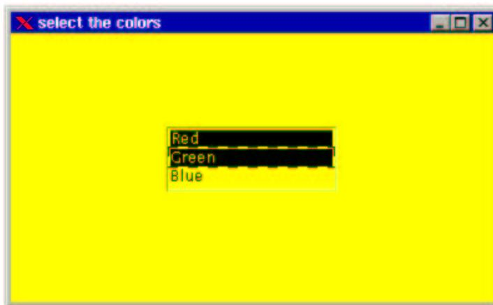
Abbildung 2.18: Beispiel für die Programmierung einer Auswahlliste mit mehrfacher Selektion.
