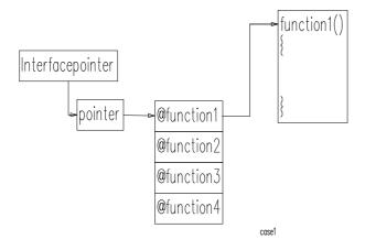
Bei InProcessServer erfolgt der Zugriff auf die COM Objekte wie auf C++ Objekte mit virtuellen Methoden In den anderen Fällen stellt die COM Bibliothek automatisch die Proxys und Stubs zur Verfügung und realisiert die RPC Zugriffe.
