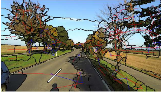
Abb. 4: Bild der Frontkamera mit Schattensegmentierung nach [2]. Rote Kanten verbinden Regionen mit der selben Beleuchtungsklasse und blaue Kanten Regionen mit unterschiedlicher Beleuchtung.
